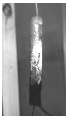
Рис. 5. Общий вид испытываемого образца после испытаний (обугленный)
