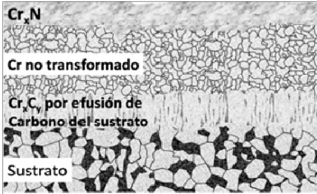
Figura 2 . Esquema que representa la microestructura de un proceso dúplex cromado electrolítico y nitruración (elaborado por los autores).
