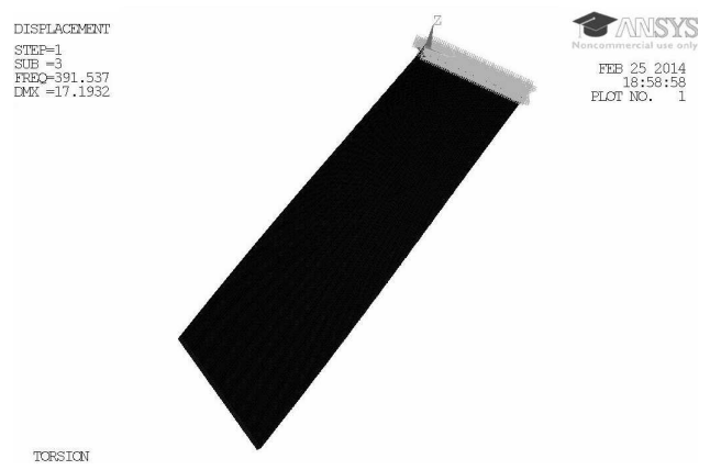
Fig. 5. The first torsional eigenmode ( f = 391.5 Hz).
