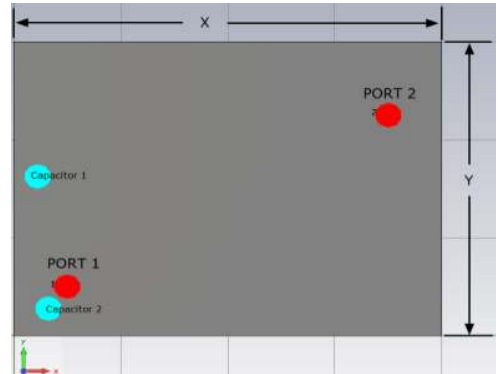
그림 6. 디커플링 캐패시터의 용량 및 위치결정 Fig. 6 Positioning and capacity of the decoupling capacitor
