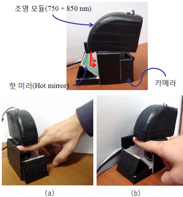
(그림 1) 제안하는 손가락 정맥 영상 취득 장비의 견본(prototype) : (a) 제안하는 장비 (b) 장비를 사용하는 예[11]
