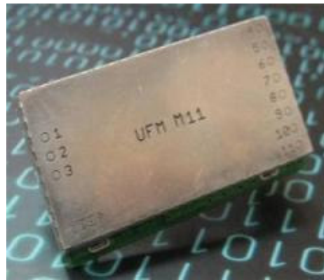
Figure 2. UDEA UFM-M11 RF Module.
