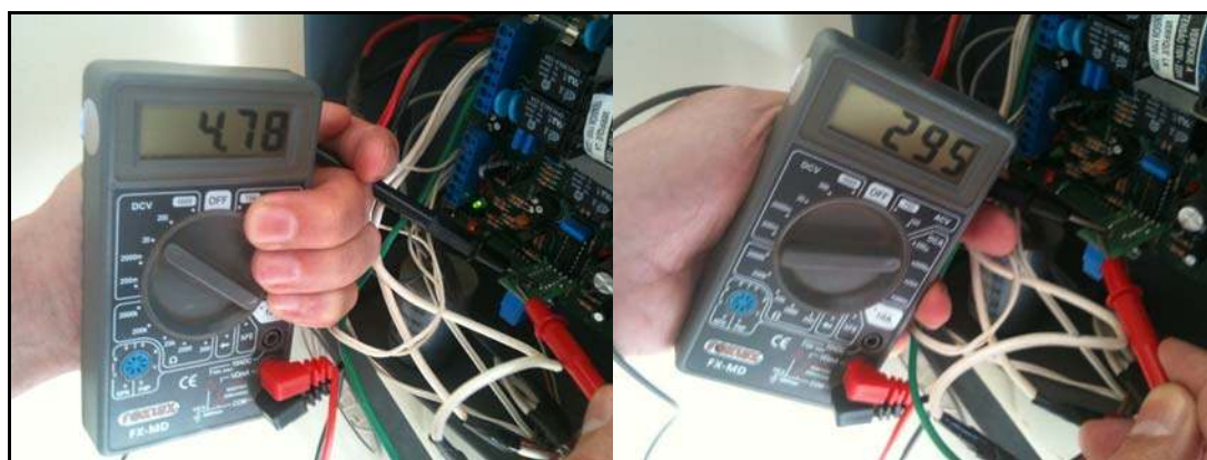
Figura 4.6 – Tensão em volts (à esquerda) e a corrente em \mu A (à direita) do portão elétrico utilizado no projeto. Fonte: AUTOR
