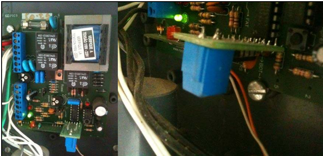
Figura 4.5 – Placa do portão (à esquerda) e botoeira em destaque (à direita). Fonte: AUTOR
