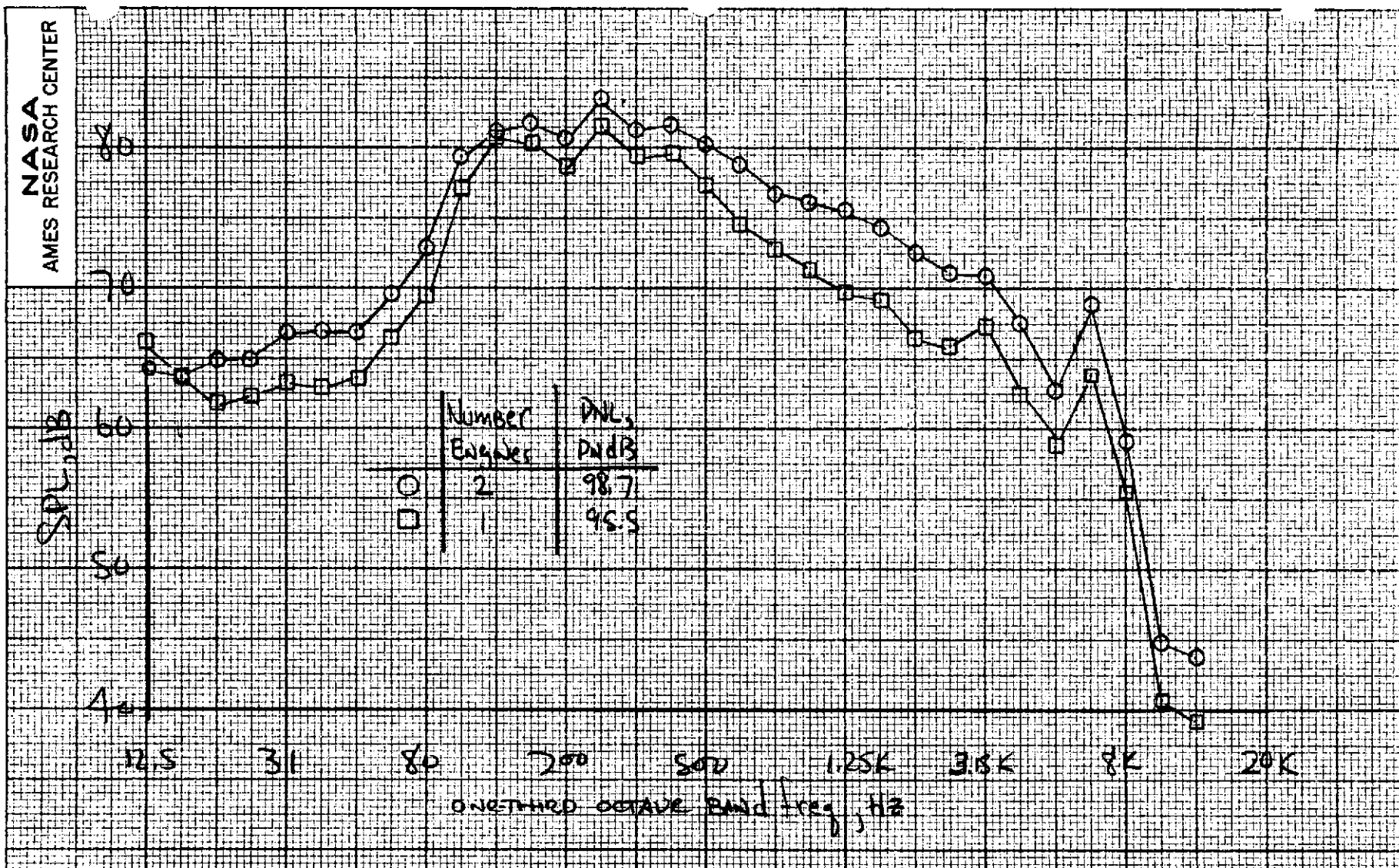
(d) Frequency spectra, S/L angle = 130^\circ , V_J = 247 m/s (810 fps).
