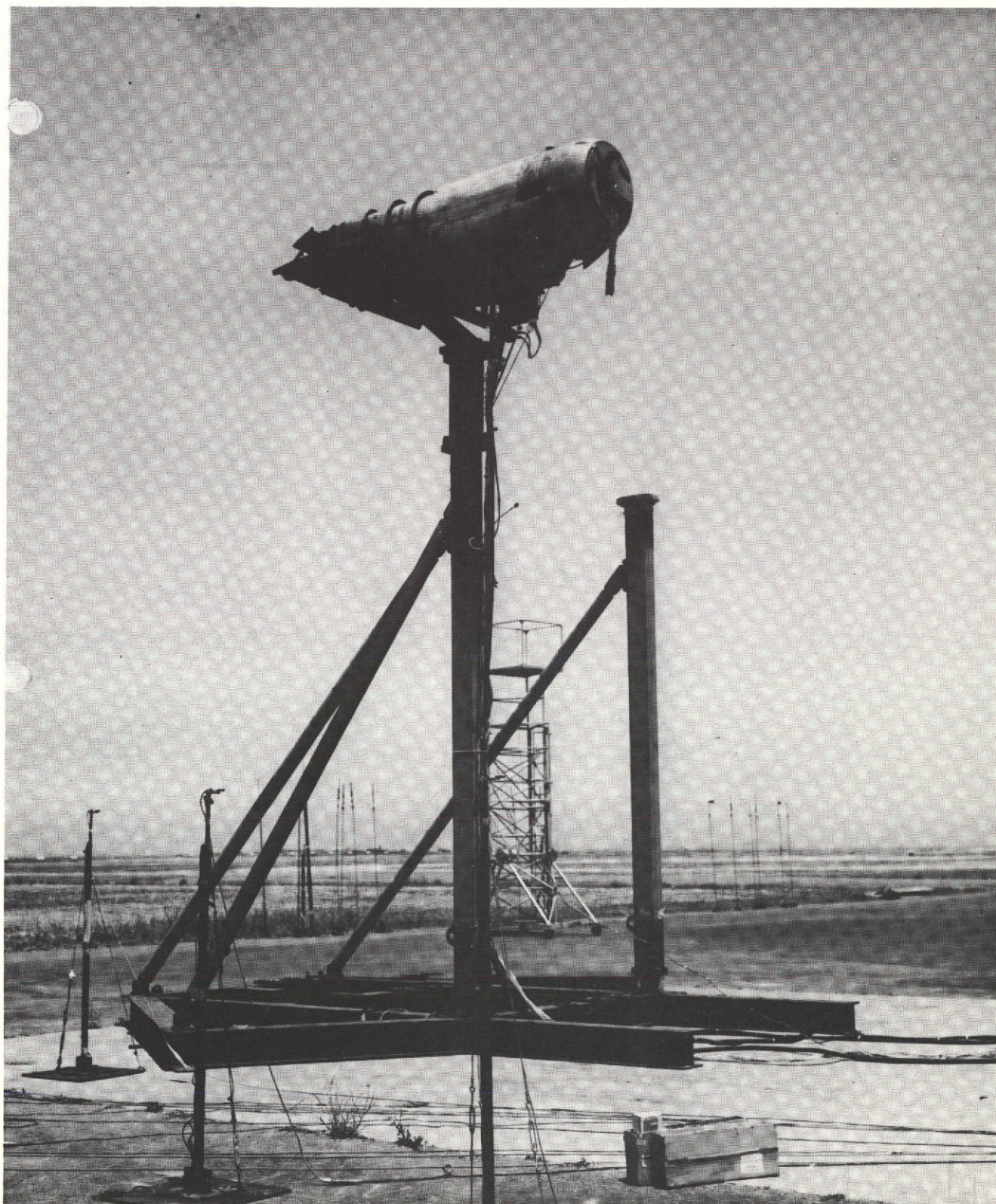
(d) Nacelle installed in static test facility
