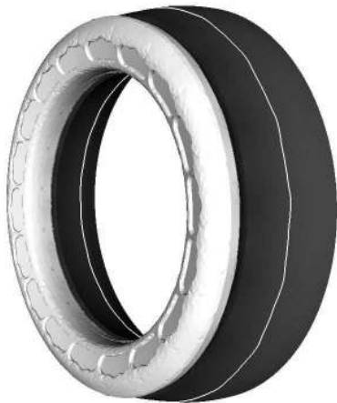
c: First longitudinal mode - f = 846 Hz
