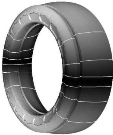
a: First orthoradial mode - f = 344 Hz
