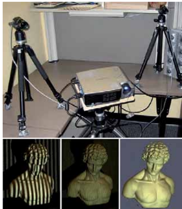
Rys. 8. Przykład wykorzystania światła strukturalnego do modelowania obiektów; od góry – układ pomiarowy; na dole dwa wybrane etapy oświetlenia prążkami Graya i wynikowy model otrzymany po oświetleniu 40-toma wzorcami [web.media.mit.edu/~dlanman]
