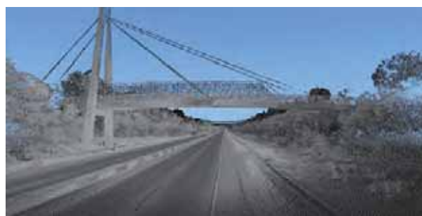
Rys. 3. Chmura punktów zintegrowana z kilkudziesięciu odczytów laserowych [www.igi.eu]
