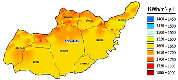
Şekil 1. Adıyaman İli Güneş Enerjisi Potansiyel Haritası (EİE 1985-2015)
