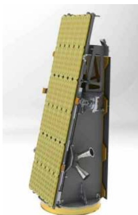
Fig. 14. Antenna in NovaSAR-S.
