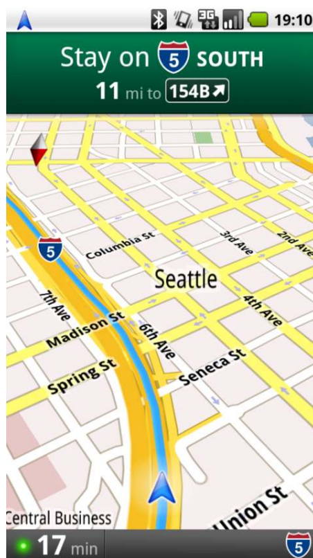
Figura 1.11: Google Navigator. Il led in basso a sinistra indica la congestione del traffico nel percorso. A seconda della congestione nel tragitto può essere: verde, giallo e rosso
