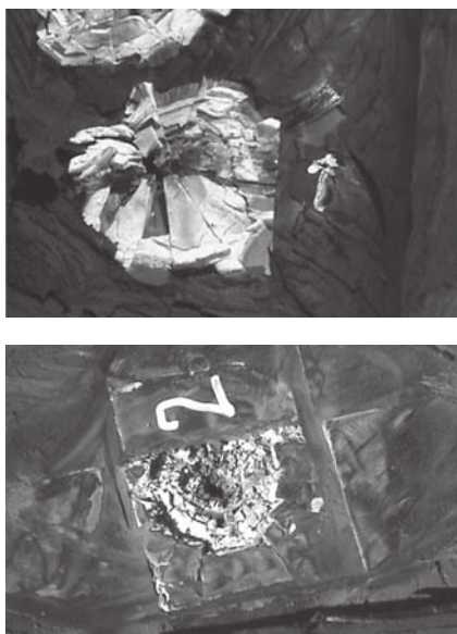
Fig. 2. Typical destruction of ceramic items during high speed collisions 2. ábra Kerámia lapkák tipikus roncsolódása a nagy sebességű ütközés során
