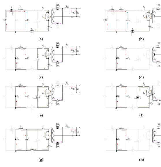
**Figure 5.** The proposed IBAHB operating modes: (a) Mode 1  $[t_0, t_1]$ , (b) Mode 2  $[t_1, t_2]$ , (c) Mode 3  $[t_2, t_3]$ , (d) Mode 4  $[t_3, t_4]$ , (e) Mode 5  $[t_4, t_5]$ , (f) Mode 6  $[t_5, t_6]$ , (g) Mode 7  $[t_6, t_7]$  and (h) Mode 8  $[t_7, t_8]$ .
