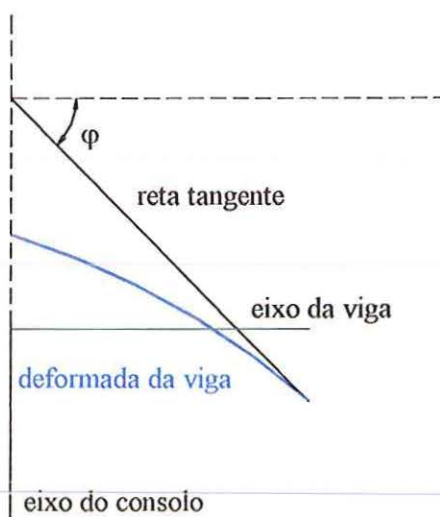
Figura 5.33 - Eixo deformado da viga.
