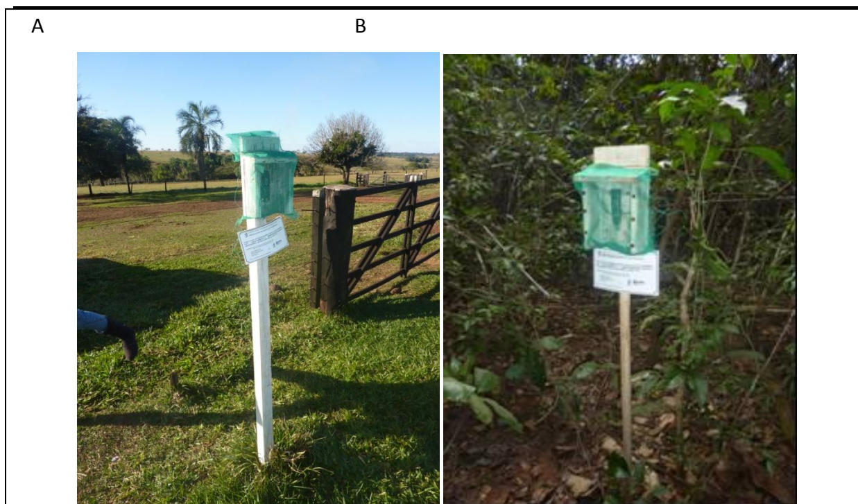
Figura 3 A e B – Termohigrômetros instalados fora das FES e no interior das FES Fotos: Lima (2013).
