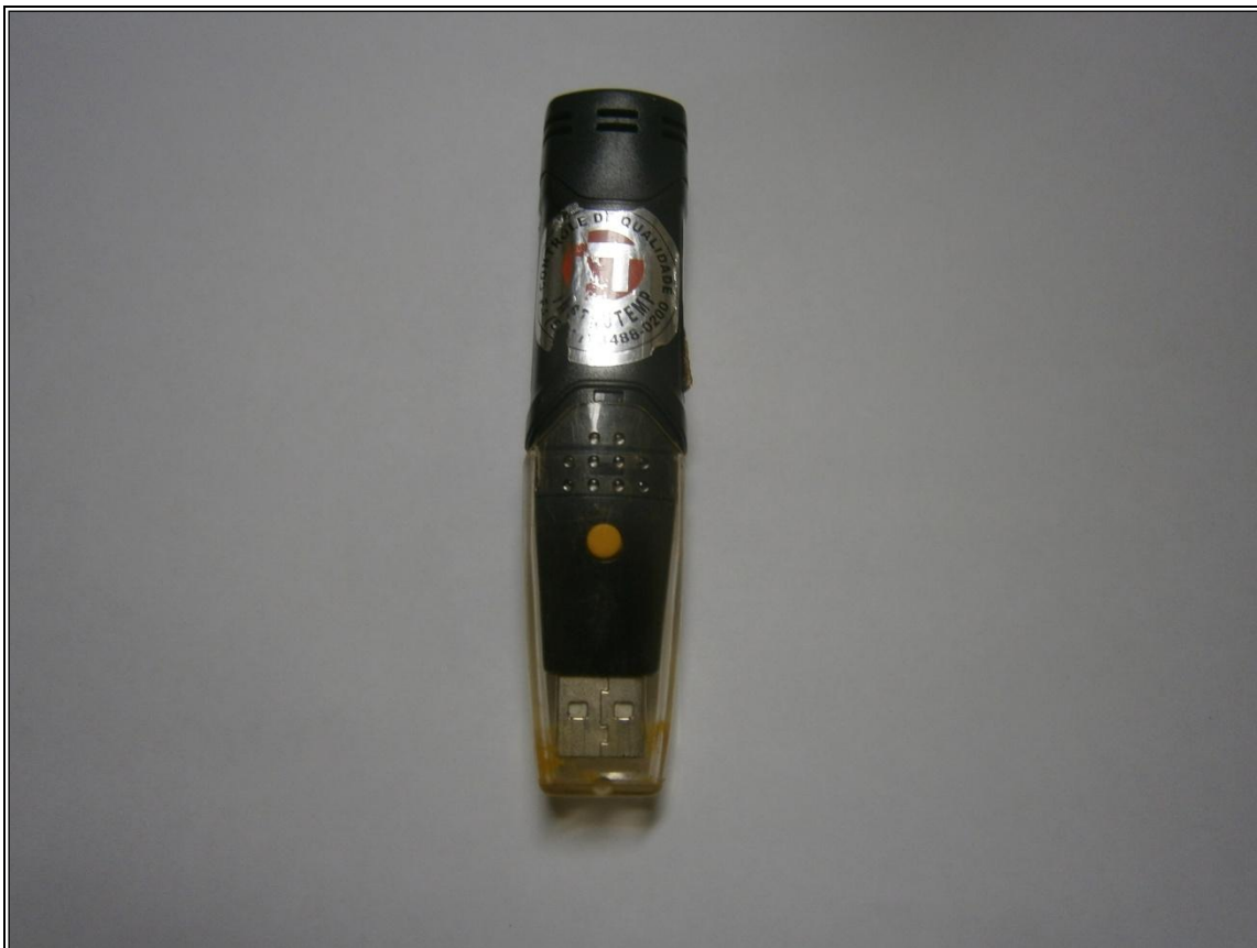
Figura 2- Termohigrômetro, aparelho coletor de temperatura e umidade do ar, na bacia da Usina Hidrelétrica Caçu (UHE-Caçu) Foto: Lima (2013).
