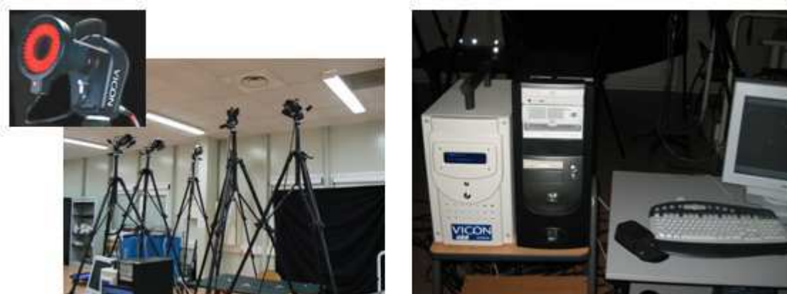
Figure III.1 : Photo du système Vicon. Caméra Vicon à gauche et unité centrale reliée à un ordinateur à droite.
