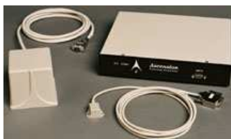
Figure IV.1 : Système Flock of bird composé d'une source (à gauche), d'un boîtier et d'un capteur (en bas).
