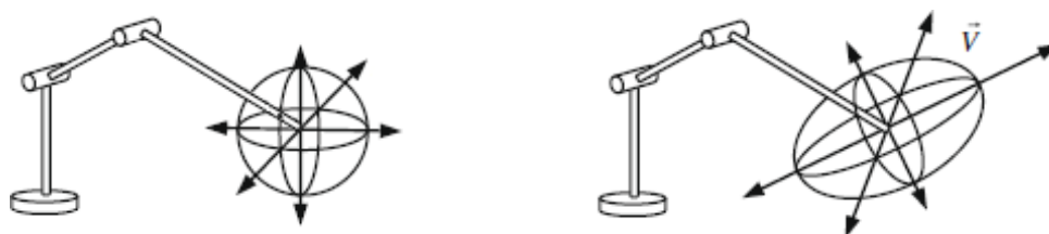
Figure II.2 : Illustration de l'isotropie de l'ellipsoïde de manipulabilité : ellipsoïde isotrope à gauche et non isotrope à droite.
