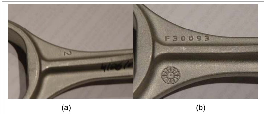
Figure 11 Inscriptions sur le bras central de la bielle (a) le numéro d'empreinte, (b) la référence de la pièce et le dateur.
