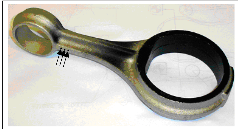
Figure 20 Zones d'impact du faisceau collimaté des rayons X pour les trois mesures de spectrométrie.
