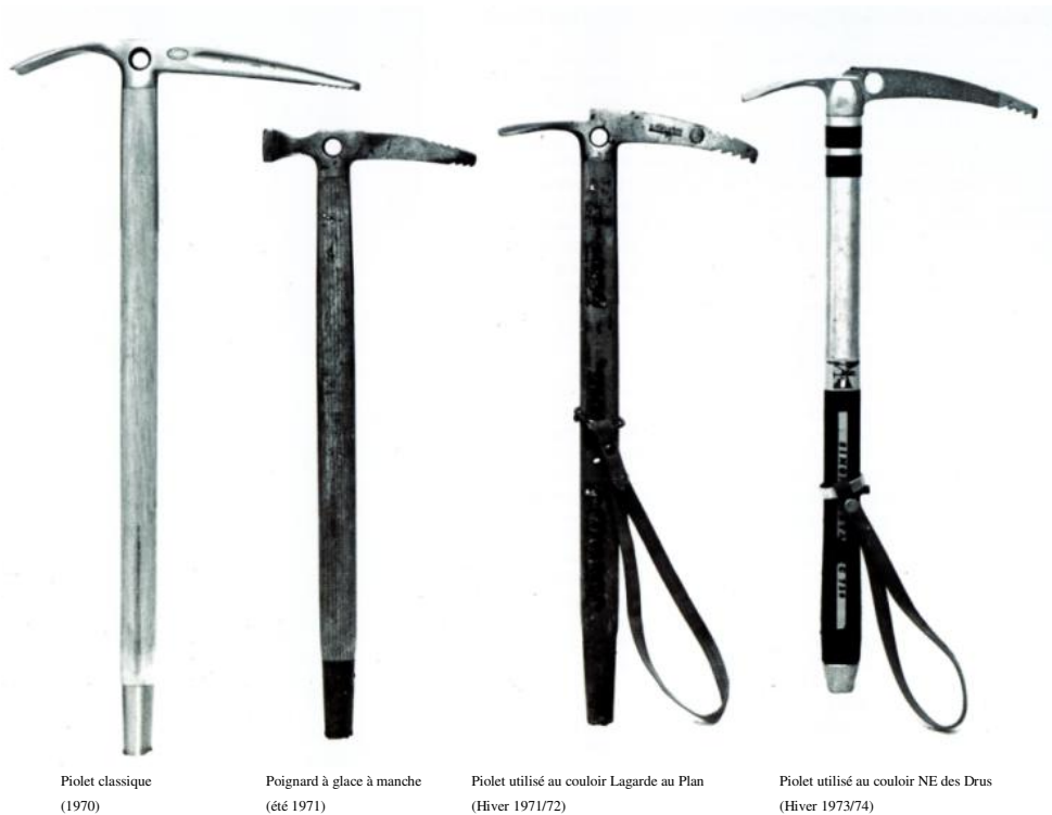
Figure 11. Processus de concrétisation du piolet pour l'ascension de couloir de glace entre 1970 et 1974 (Blanc-Gras & Ibarra, 2011)
