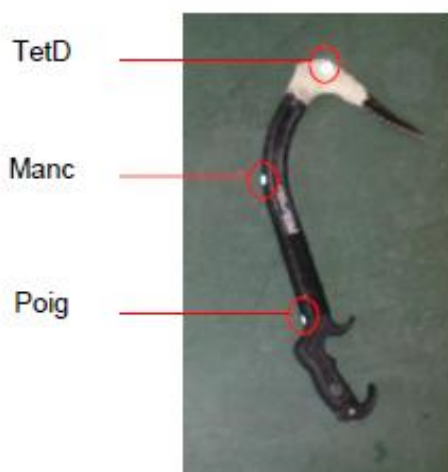
Figure 29. Disposition des marqueurs sur le piolet
