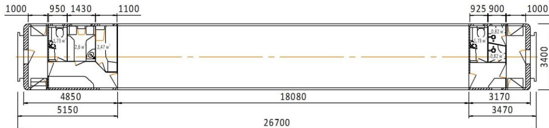
Рис. 5. Компонувальна схема sV–202 двотамбурного вагона з двома туалетними приміщеннями з пеленальними столиками та двома душовими кабіннами
