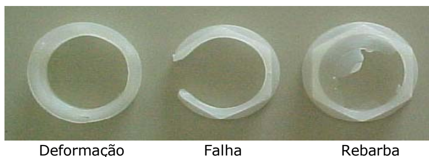
FIGURA 3.7 - DEFEITOS NO COMPONENTE PLÁSTICO
