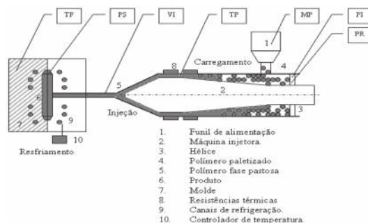
Figura 2. Processo de injeção de polímeros.
