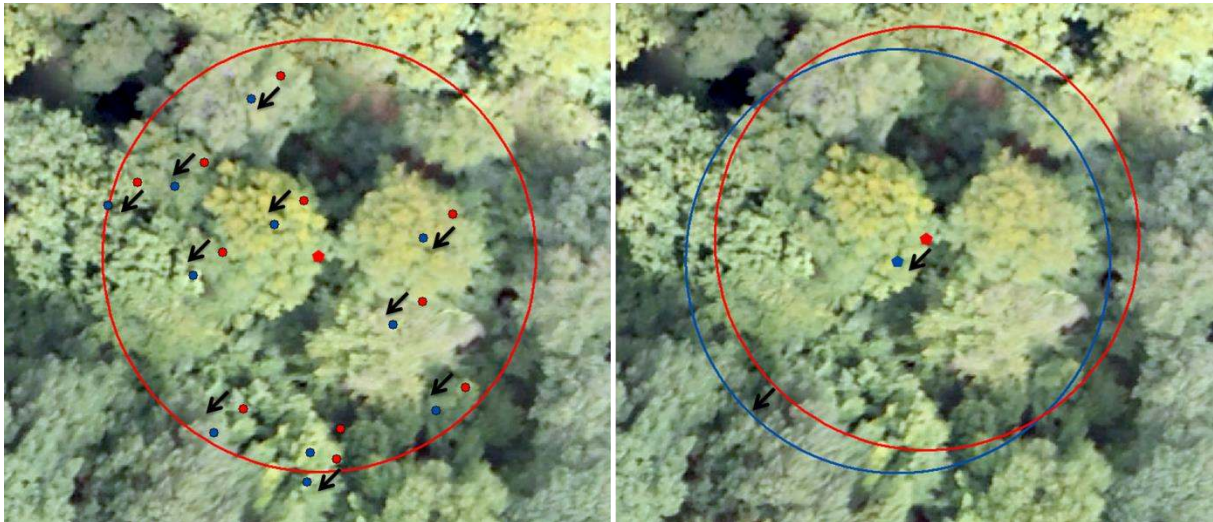
Figure 5 : Illustration du repositionnement de la placette 07/15 via photo-interprétation de la position des arbres sur l'ortho-image 2017. A) En rouge, les arbres et la placette théoriques positionnés à partir des données de l'IFA (points et cercle rouges). Repositionnement des arbres sur l'ortho-image (points bleus). Chaque arbre est déplacé avec la même direction, le même sens et la même distance afin de faire coïncider la position théorique et le houppier observé sur l'ortho-image B) Finalisation du repositionnement de la placette par translation du centre.
