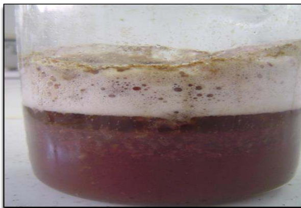
Figura 3.2.3- Amostra de óleo/gordura após a extração com autoclave
