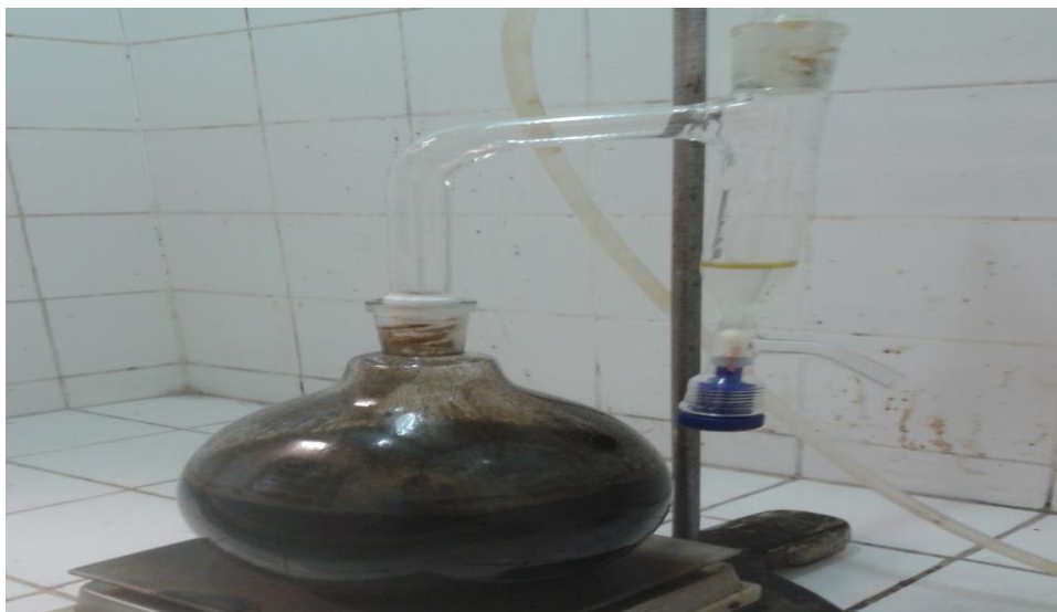
Figura 4.4.3 - Separação da água do bio-óleo de Pirólise
