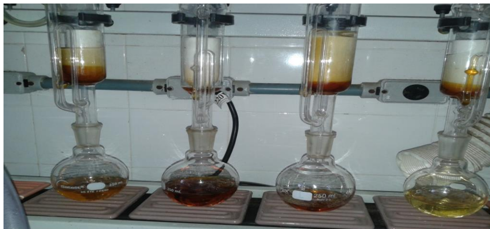
Figura 4.2.5- Processo de extração contínua do bio-óleo de pirólise.
