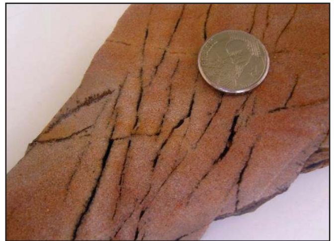
Figura 5 - Amostra de mão mostrando pequenos planos abertos com alteração ao longo das paredes indicando percolação de água em uma porção silicificada e de pouca porosidade residual matricial da Formação Raizama
