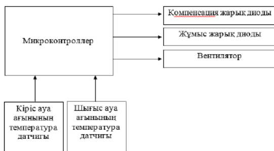
Сурет 2 – Ауаны жылытудың басқару жүйесінің құрылымдық сұлбасы
