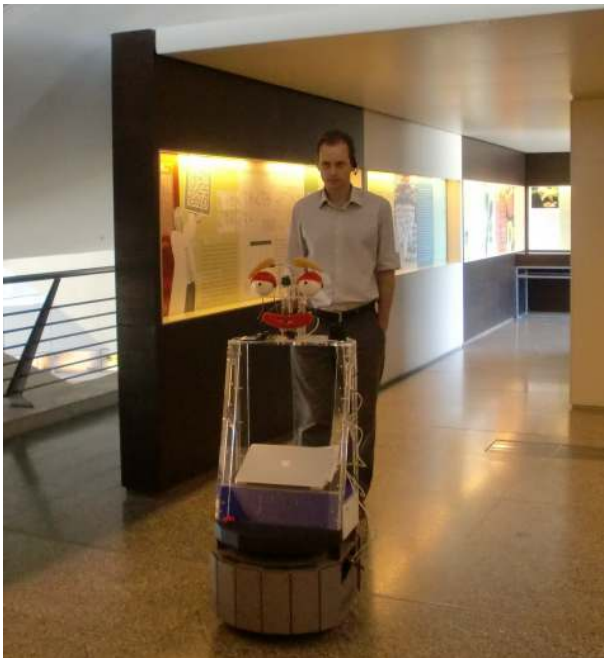
Figura 16. Doris guía a una persona hacia el punto de interés que se le ha solicitado por medio de un comando de voz. Para ello Doris planifica sobre el mapa de navegabilidad generado en la fase de configuración inicial.
