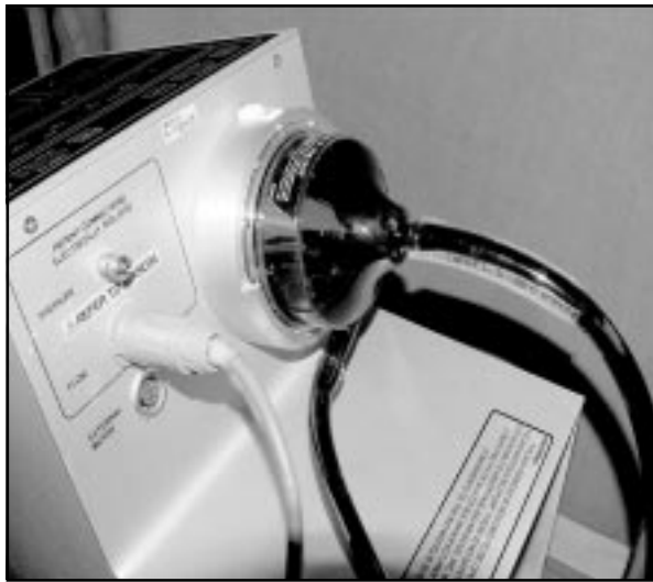
Figura 7. Bomba centrífuga en funcionamiento con su sistema de cánulas de conexión y cono de aspas de acrílico que giran para aspirar e impulsar la sangre.
