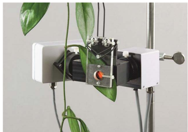
叶片状样品测量用特制叶夹
