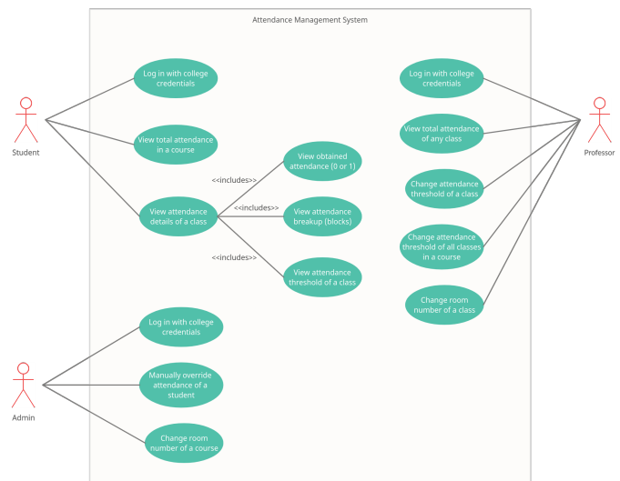
Fig. 1. UML use case diagram.
