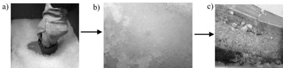
3.7 pav. SLVM dangos gamyba ir paruošimas: a) ledo kubelių susmulkinimas; b) paruoštas mišinys; c) būgno paviršius sumetus mišinį.
