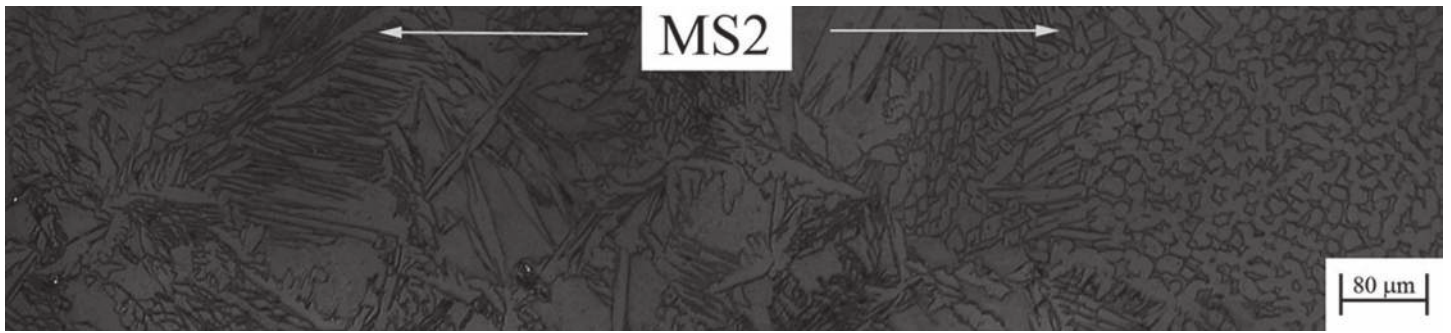
Figura 16. Metal de solda (MS2) da JPF5. Perfil ao longo do cordão solda (MS2). Variação de morfologia e da proporção de fases ao longo de um pequeno comprimento da junta.
