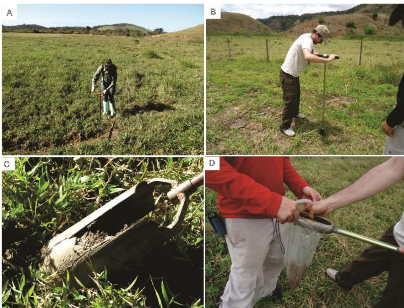
Figura 3.6- (A) (B) (C) Coleta de sedimentos utilizando trado manual. (D) Armazenamento do sedimento coletado.
