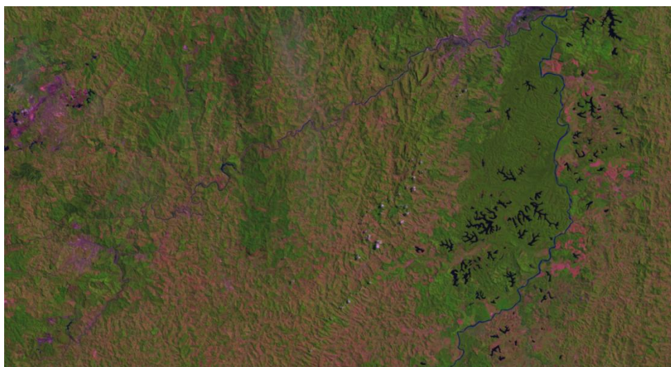
Figura 3.2- Recorte da cena 217-74 Landsat TM-5. Foi utilizada a composição colorida nos canais 543 das bandas RGB, respectivamente.
