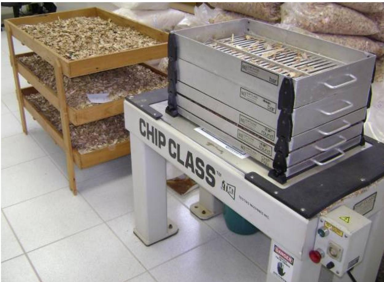
Figura 2 - Classificador elétrico com peneiras vibratórias (dir.) e bandejas para homogeneização da umidade dos cavacos (esq.)
