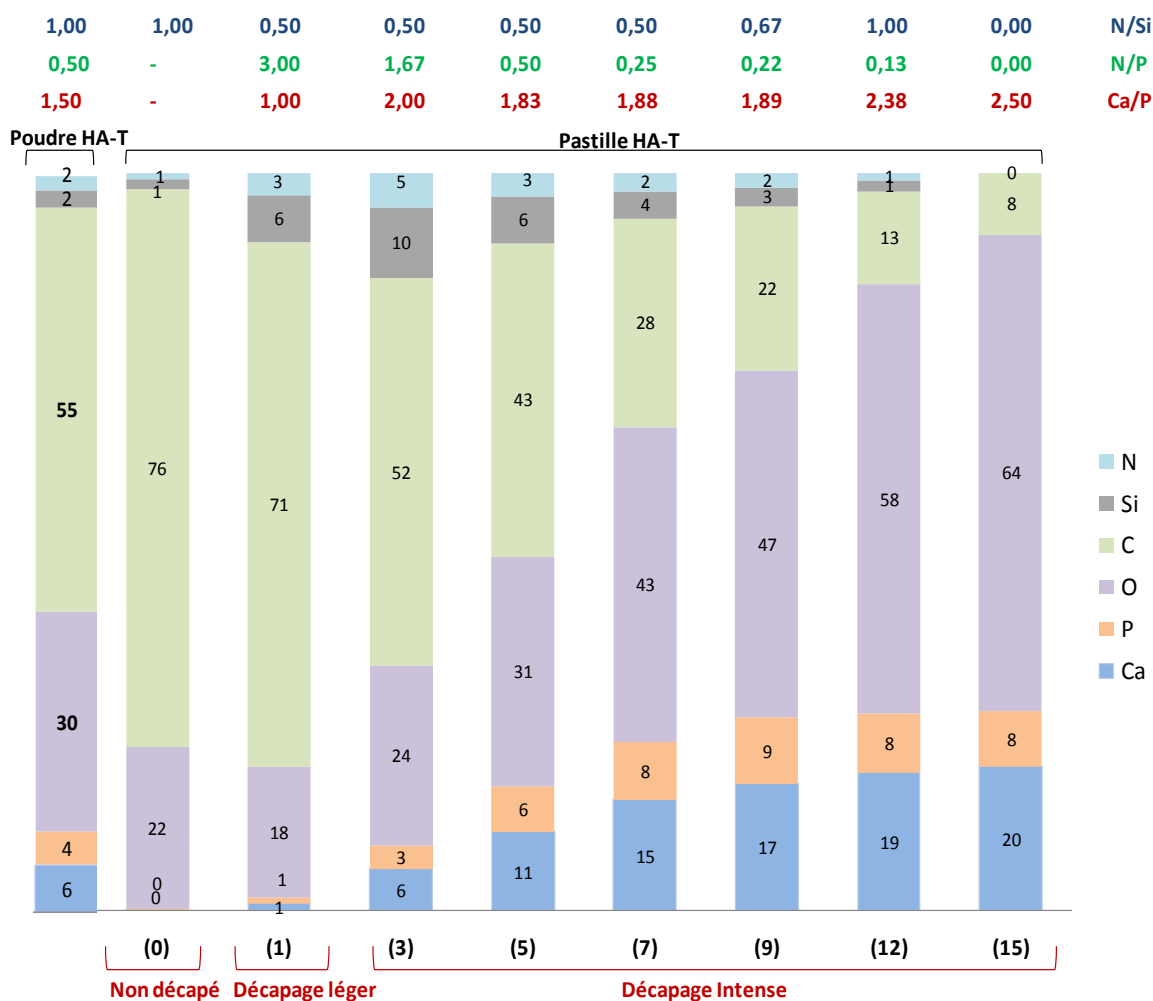
Figure III-12 : Evolution des pourcentages atomiques des éléments chimiques présents à la surface de la poudre d'HA-T et de la pastille d'HA-T après des décapages ioniques successifs. Les temps cumulés (min) de décapage sont indiqués entre parenthèses
