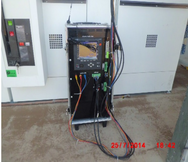
Şekil 2. Kullanılan Şebeke Analizörünün Bağlantı Şekli
