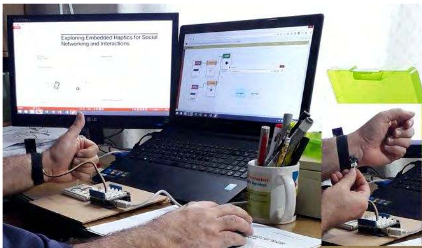
Fig. 5.32.: Demo Feel Messenger. Prueba de boceto enactivo. El boceto de la experiencia puede ser algo tan simple como combinar un par de botones GUI en una pantalla y un Motor DC colocado dentro de una muñequera (ver imagen interna)
