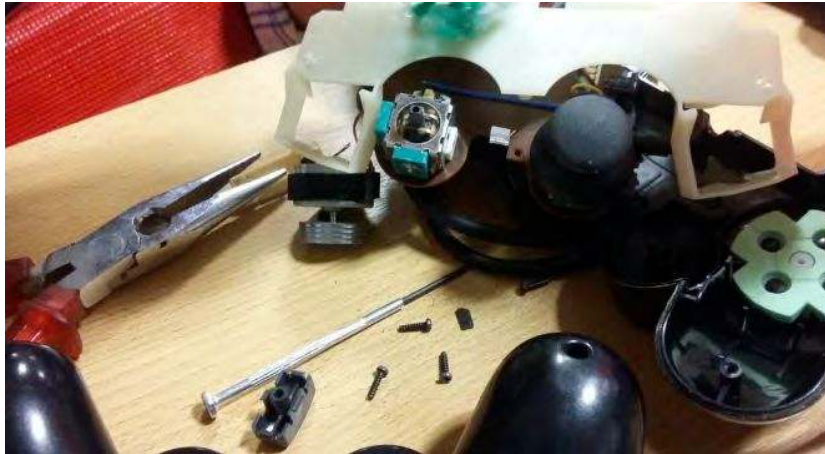
Fig. 4.32.: Empatheia. El proceso incluyó diversas actividades de tinkering y desguace, en este caso de un controlador de juegos para extraer los motores vibradores
