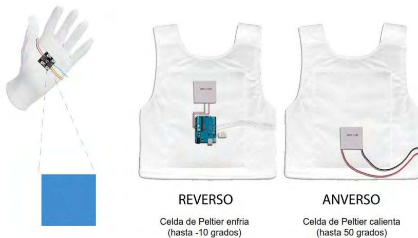
Fig. 4.20.: Proyecto Color por Calor. Idea general de sensado en guante y actuado en chaleco
