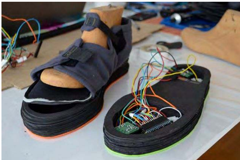
Fig. 4.24.: Proyecto zapatillas para ciegos. Boceto de zapatilla utilizado en la demo final
