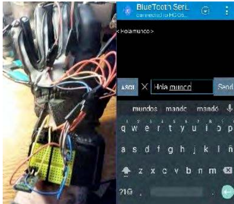
Fig. 4.28.: Letras en los dedos. Segundo boceto en hardware, incorporando el módulo Bluetooth y el Arduino Nano, con el boceto de aplicación Android para recibir el input mediante texto escrito
