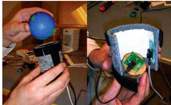
Fig. 5.28.: Boceto en hardware para un MP3 Player controlado por gestos (fotografía de Sketching User Experiences[32])
