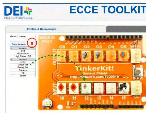
Fig. 3.14.: Captura de pantalla de la interfaz ECCE para definir entidades interactivas conectadas a la placa Tinkerkit. El usuario hace drag&drop del sensor o actuador desde la paleta al puerto deseado. Tomado de [20]
