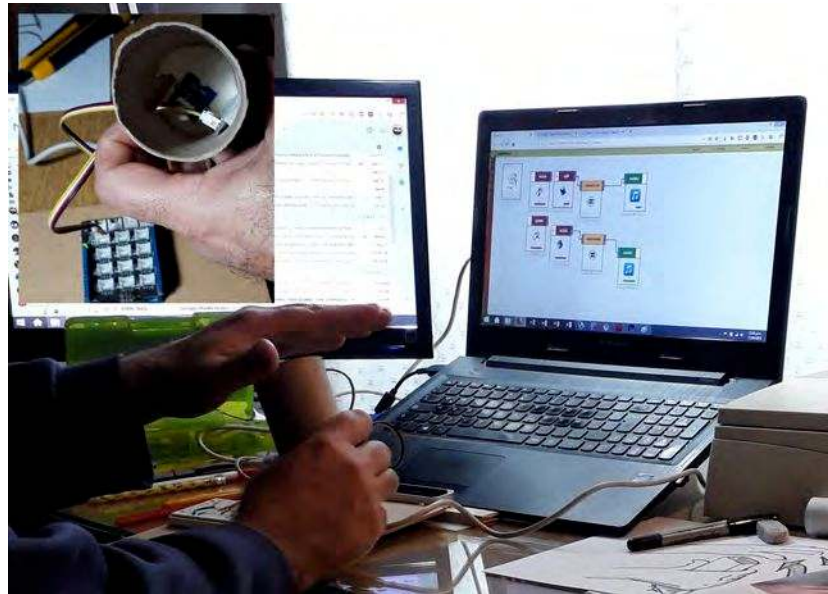
Fig. 5.30.: Demo Audio Player. Construcción y prueba de boceto con hardware. En el insert, el detalle del boceto con un sensor LDR y un acelerómetro incluido (para modificar la luz que ingresa simplemente se cubre parcial o totalmente la abertura con la mano). En la foto principal, el diseñador prueba su boceto hardware después de haber modificado la composición de sketgets en el Cuaderno de Pluma
