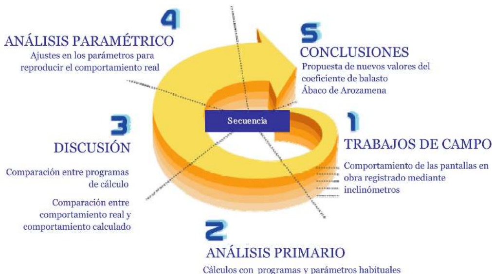
Figura 1. Secuencia de trabajos realizados.
