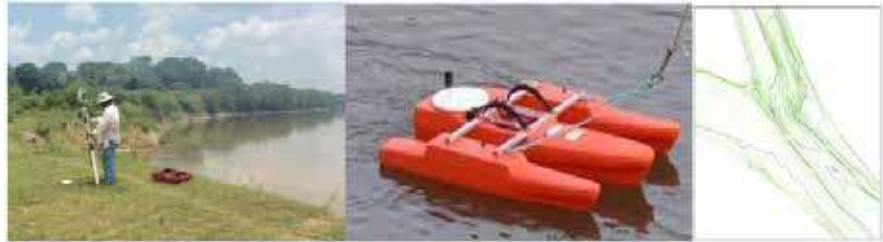
Figura 2. Levantamiento de geometrías complejas, con equipo estación total (Leica Ts06 Plus) y ADCP (Riverray).
