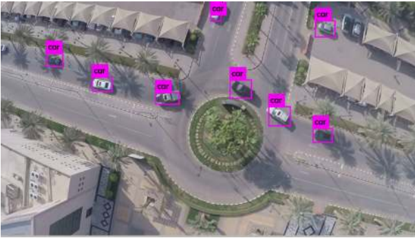
Fig. 4. Car detection using Yolo v3
