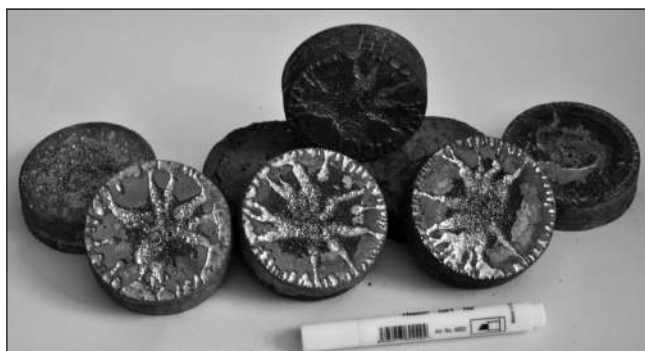
Рис. 2. Внешний вид образцов литых СВС-сплавов на основе NiAl
