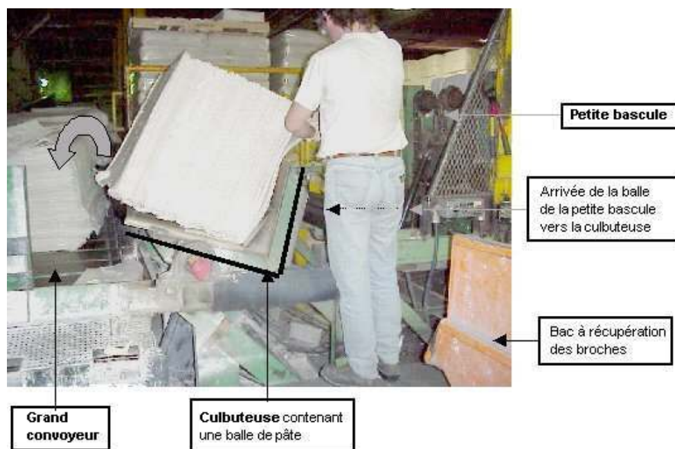
Figure 3. Poste de chargement machine 7
