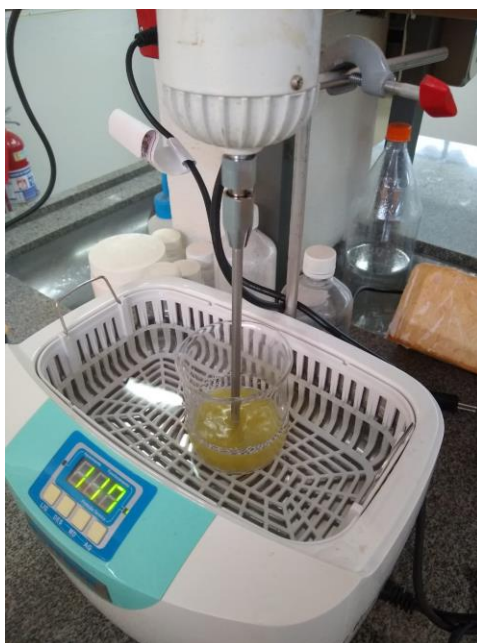
Figura 1. Sistema de ultrassom com um agitador mecânico.
