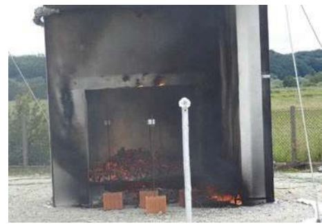
Slika 14. 54 minute nakon početka – tinjanje uzorka EM_2
