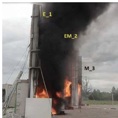
Slika 23. Razvija se gusti dim i goruće kapljice padaju na tlo (uzorak E_1): 25 minuta nakon početka
