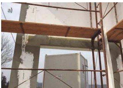
Slika 5. Protupožarna barijera: a) postavljena na uzorku EM_2; b) shema - presjek [14]; c) shema - pogled [14]
