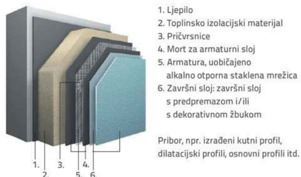
Slika 1. Komponente ETICS sustava [3, 4]
