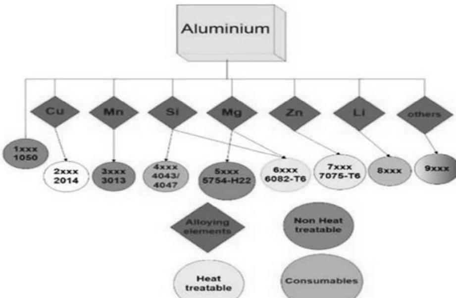
**Figure 1.** Grouping of aluminium alloy [3]**Slika 1.** Grupe alumijumskih legura [3]
