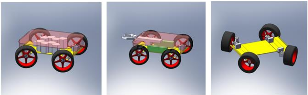
Figura 9 - Modelos iniciais do RoboDeck apresentando a questão do posicionamento das baterias, da pinça mecânica e da capacidade de girar sobre o próprio centro Fonte: Própria
