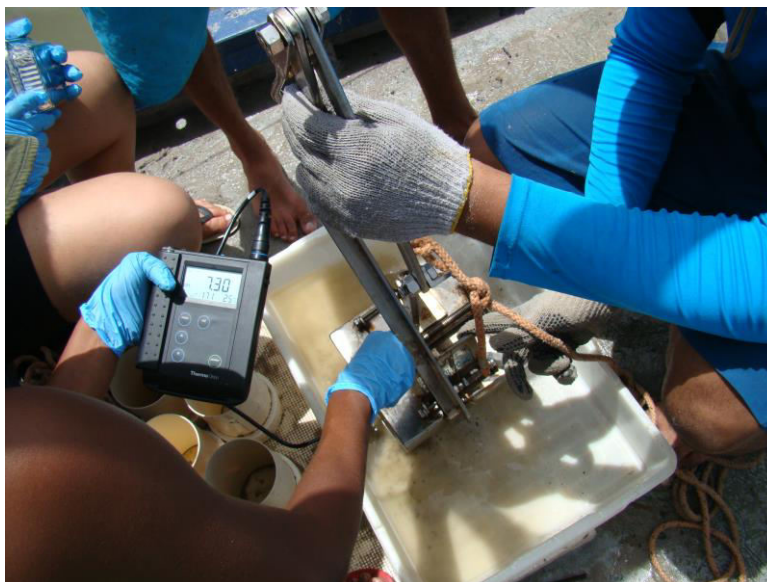
Figura 7. Medições in situ de alguns parâmetros físico-químicos (pH, salinidade, etc.) durante uma coleta de amostras no Rio Subaé, BTS
