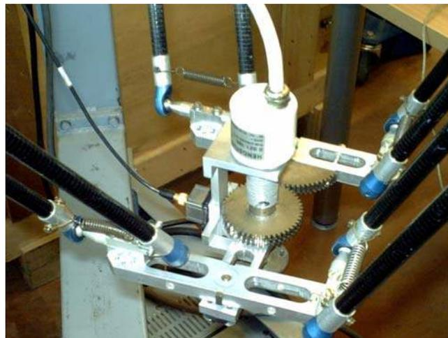
**Figure B.** Détail de la nacelle et son mécanisme d'amplification
