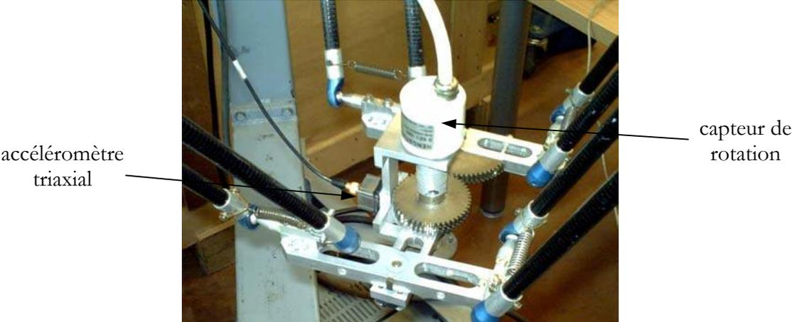
Figure 2.4. Capteurs additionnels ajoutés à la nacelle
