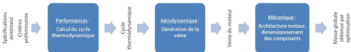
Figure I.2 – Trois étapes majeures de la phase avant-projets
